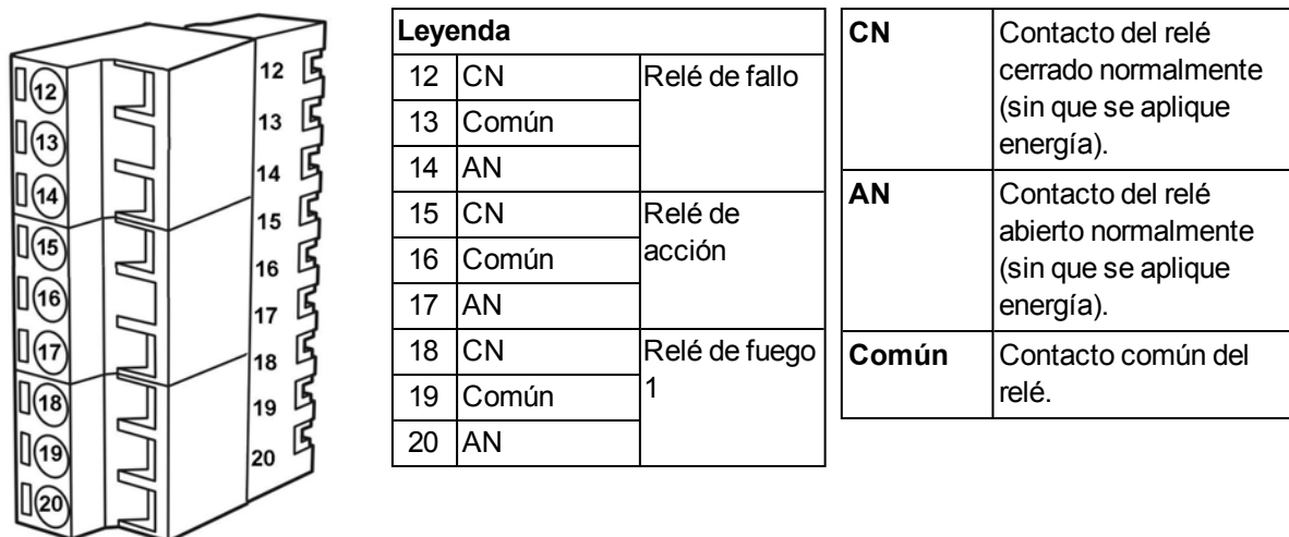
Figura 2-12: Pantalla del bloque del terminal, relés
